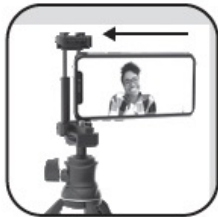
Telefon einsetzen und obere Klemme loslassen
